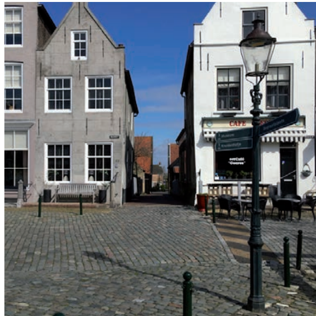
wegwijzer gecombineerd met lichtmast
