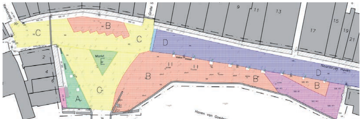
overzicht van bestaande granietkeien. Vakken C, D en E zijn (grotendeels) herbruikbaar, de vakken A en B grotendeels niet.
